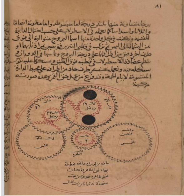
مخطوط يشرح التركيب الداخلي للإسطرلاب، وهو آلة اخترعها المسلمون لمعرفة الوقت والاتجاه والإحداثيات
